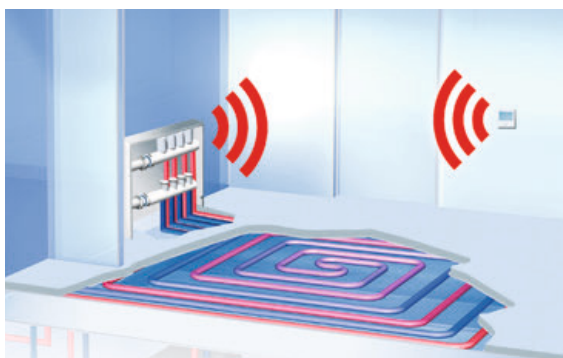
Abb. 67: Regelung des Heizkreisverteilers über eine funkgesteuerte Einzelraumregelung
