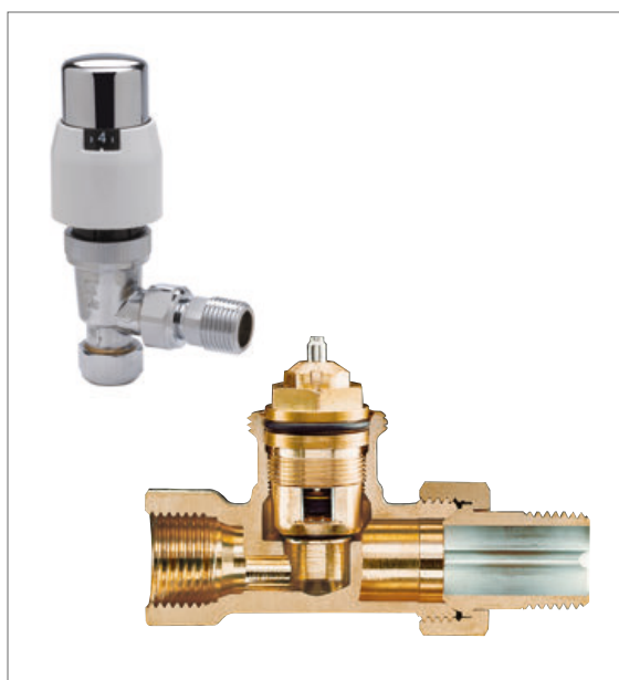
Abb. 58: Ventil mit voreinstellbarem Ventileinsatz zur Anpassung der Volumenströme an die geforderte Heizlast
