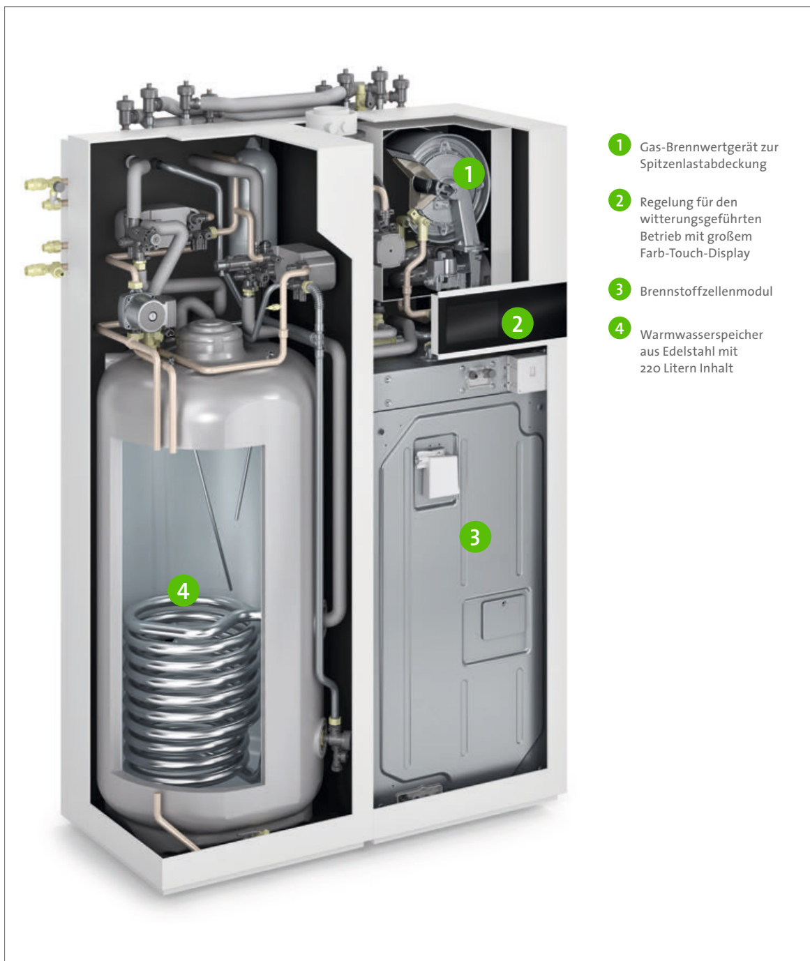
Abb. 48: Komponenten einer Brennstoff- zellenanlage
