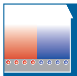
Bild 5: Bodenaufbau – Tackersystem, Decke gegen beheizte Räume (DIN EN 1264-4)
