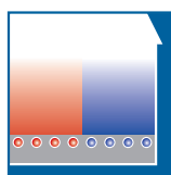
Bild 4: Bodenaufbau – Noppensystem, Decke gegen beheizte Räume (DIN EN 1264-4)
