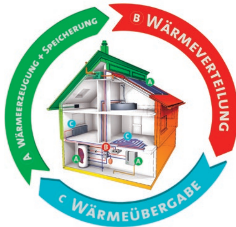
Bild 02: Komponenten eines Heizsystems im Einfamilienhaus.
