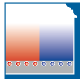
Bild 4: Praxisbeispiel Bodenaufbau – Dünnschichtsystem als schwimmende Konstruktion
